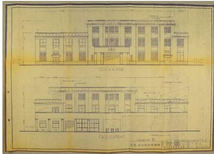
高松港務所の工事報告には昭和 2 年(1927)4 月 5 日に起工し、同年 9 月 10 日に竣工、鉄筋コンクリート 3 階建総延坪 335 坪 8 合、総工費 7 万 4346 円、就業職工延人員 5700 余人を要したと記されている。その後昭和 28 年(1953)に高松港湾事務所、昭和 38 年に高松港管理事務所に改称され、平成 13 年(2001)5 月にサンポートの高松港旅客ターミナルビルに移転するまで利用されていた。平成 24 年 3 月に解体された。
